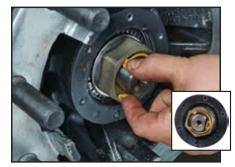
6. Instalar el anillo retenedor de la tuerca Temper-Loc y verificar la correcta instalación del retenedor.
