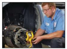
Fijar la herramienta Doctor Preload a los extremos de la rosca del eje. Con un movimiento de barrido, guiar los brazos de carga alrededor de la contratuerca, al tiempo que coloca el posicionador de la clave en la ranura. Fijar la rosca con dos vueltas de rosca con el final del eje.
