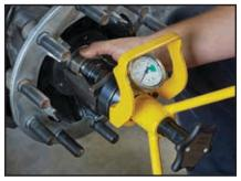
Ajustar con los dedos la tuerca Temper-Loc contra el balero; alinear el punto más cercano en la tuerca con la marca indicadora del posicionador de la clave.
