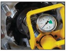
Para ajustar los baleros, aflojar lentamente la manija en T hasta que la aguja del calibrador apunte a "Ajuste Eje de Tracción/Semirremolque" o "Ajuste Eje Delantero", respectivamente.
