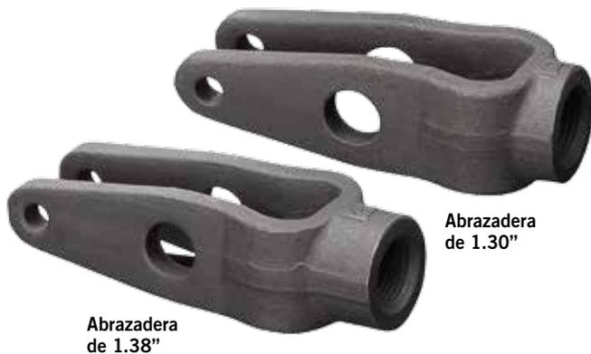
Los ajustadores ASA Meritor se venden en el mercado de refacciones sin abrazadera, lo cual permite al usuario final especificar correctamente la abrazadera para su aplicación. Meritor fabrica abrazaderas con espaciamentos de pasador de 1.30" y 1.38" para cubrir una variedad de aplicaciones. Para maximizar la vida útil de las balatas, se recomienda reemplazar la abrazadera junto con el ASA.
