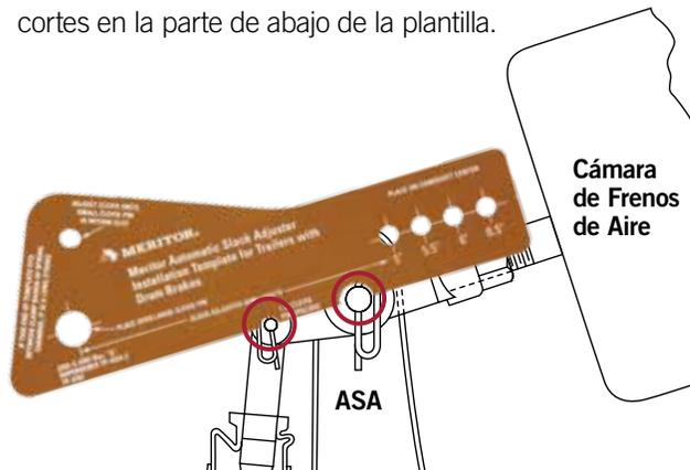
1. Use la plantilla correcta del ASA Meritor para medir la longitud del ajustador<sup>1</sup>. Las marcas que están cerca de los orificios en el extremo pequeño de la plantilla indican la longitud del ajustador.
