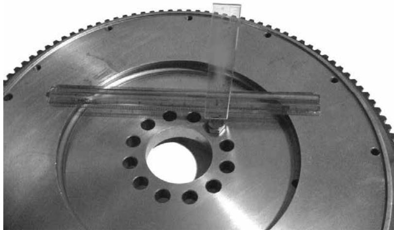
**Se requiere un mínimo de 5/16" de distancia de la superficie (cara) de fricción del volante de motor a la parte superior de la cabeza del perno que sujeta el volante de motor al cigüeñal.**
